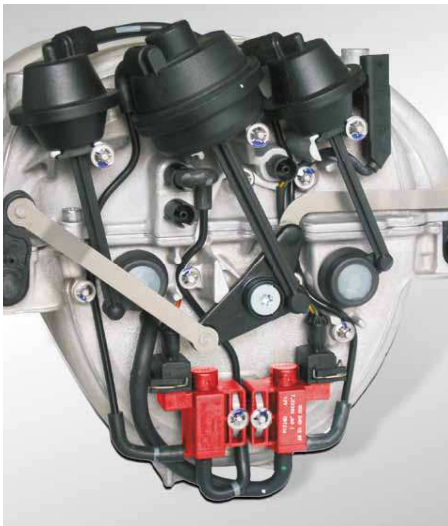
Esempi di impiego: tubo di aspirazione con valvole elettropneumatiche (evidenziate in rosso) nella Mercedes Classe C
