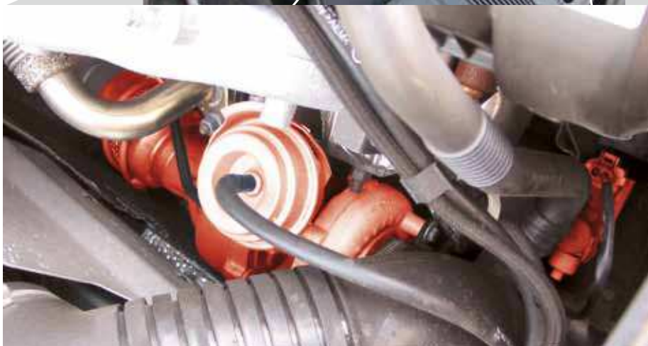
L'EPW e il compressore VTG (evidenziati in rosso) nell'Audi A4 TDI
