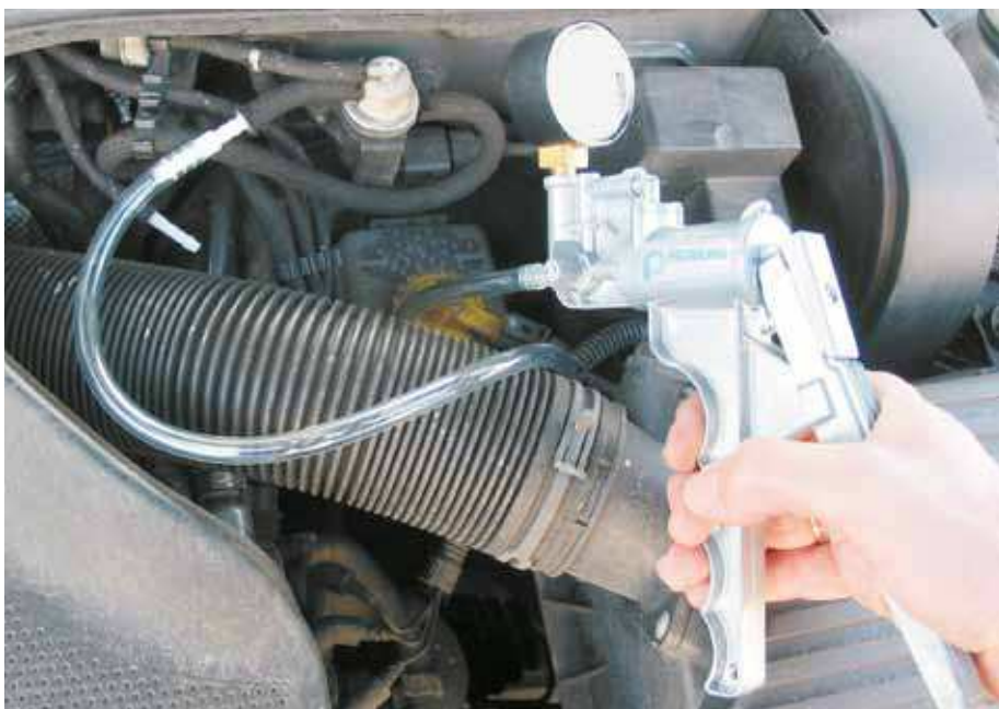
Controllo di un EPW con la pompa di depressione manuale (VW Golf IV)
