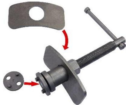
3. Den Bremskolbenrücksteller zwischen Bremskolben und Sattelrahmen positionieren.
