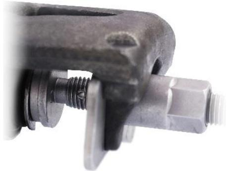
6. Indem Sie die Spindelmutter wieder im Uhrzeigersinn, oder die Spindel gegen den Uhrzeigersinn drehen, lockern Sie den Bremskolbenrücksteller und können diesen wieder entnehmen.
