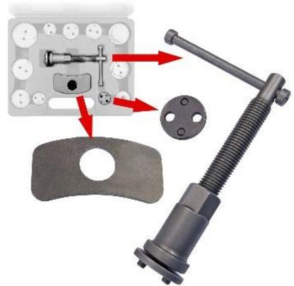
2. Indem Sie den Gleitgriff auf eine Seite schieben können Sie die Rückhalteplatte auf die Spindelmutter auflegen.
