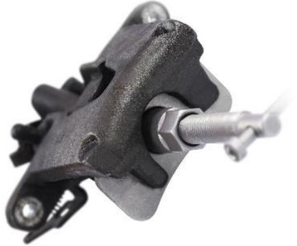
5. Durch das Drehen der Spindel im Uhrzeigersinn stellen Sie den Bremskolben zurück.
