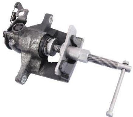
4. Bremskolbenrücksteller zwischen Bremskolben und Sattelrahmen festdrehen, indem Sie die Spindel im Uhrzeigersinn, bzw. die Spindelmutter gegen den Uhrzeigersinn drehen.
