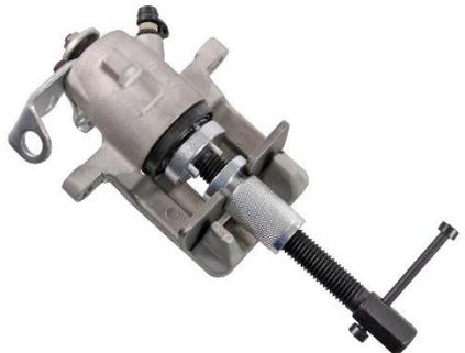
4. Bremskolbenrücksteller zwischen Bremskolben und Sattelrahmen festdrehen, indem Sie die Spindel im Uhrzeigersinn, bzw. die Spindelmutter gegen den Uhrzeigersinn drehen.
