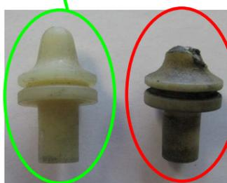
Vergleich einer neuen Auflagekugel mit einer gebrauchten.
