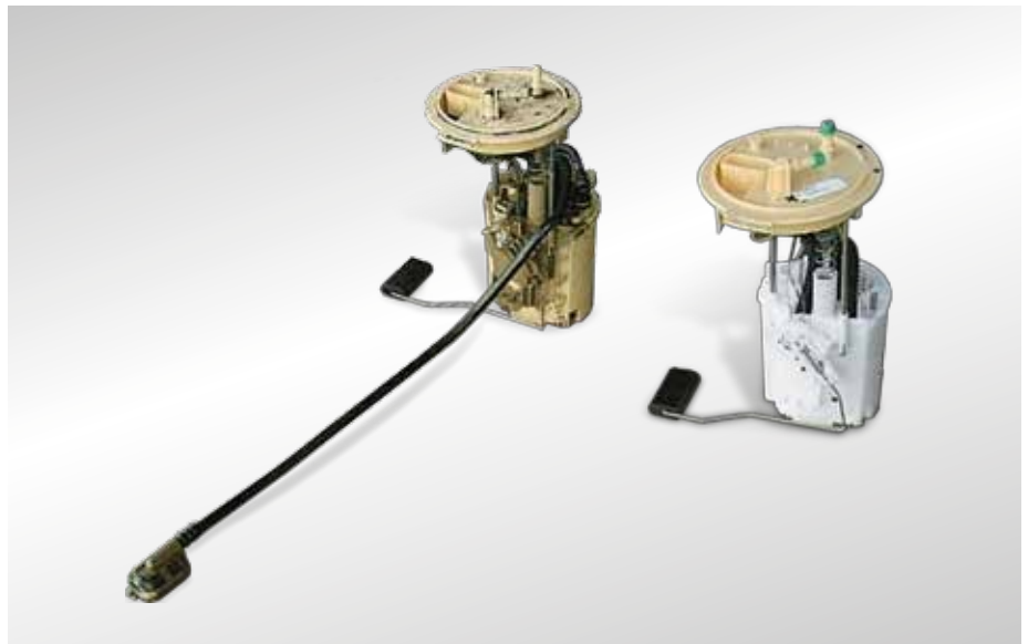
Abb. 2: links: ursprünglich verbautes Kraftstofffördermodul mit externer Saugstrahlpumpe rechts: Kraftstofffördermodul 7.02550.32.0
